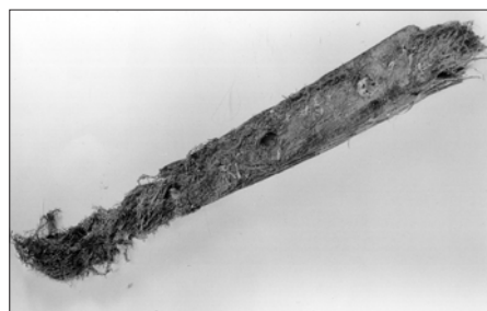
Ryc. 12. Próbką uszczelki wykonanej z mchu Drepanocladus sedtneri . Fot. A. Kaube Fig. 12. Caulking specimen made of moss Drepanocladus sedtneri . Photo A. Kaube
