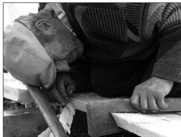
Ryc. 10. Skutnik ze wsi Basonia sprawdza ukosowanie klepek starym szablonem swojego nieżyjącego nauczyciela. Fot. R. Łapiński – fundacja Ja Wisła Fig. 10. Boat builder from the village of Basonia examines diagonal forming of the planks using an old template of his late teacher. Photo R. Łapiński – Ja Wisła Foundation
