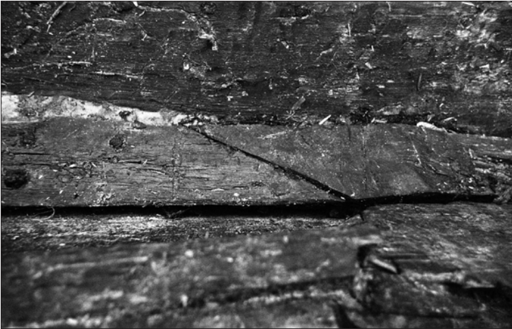
Ryc. 6. Łączenie stępki z dziobnicą. Widoczny nit żelazny. Fot. Wł. Filipowiak Fig. 6. Keel and stem joint, visible iron rivets. Photo Wł. Filipowiak
