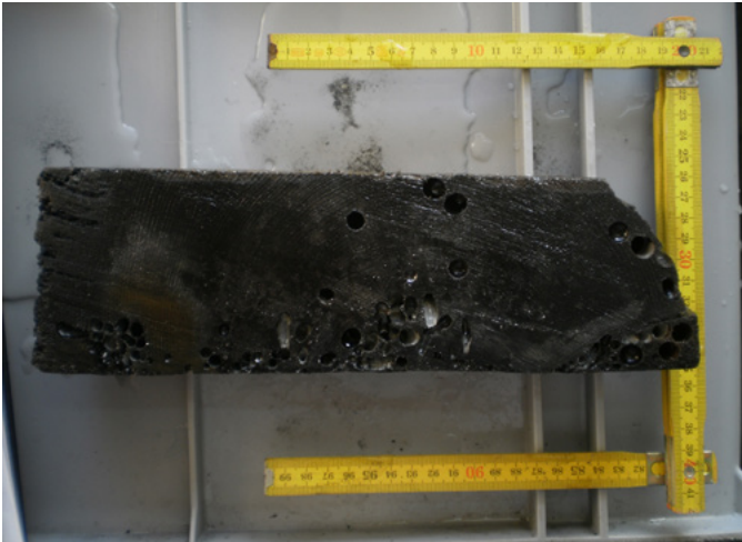
Muestras de tablas del casco de pino procedentes de La Magdalena , 18th c. Fragata española, Viveiro, Galicia | foto USC, ForSEAdiscovery
